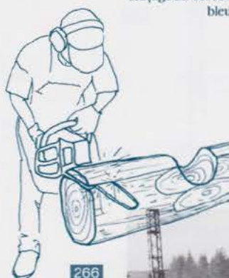
266 L'implantation : dégauchissage du 2 e demi-tour
