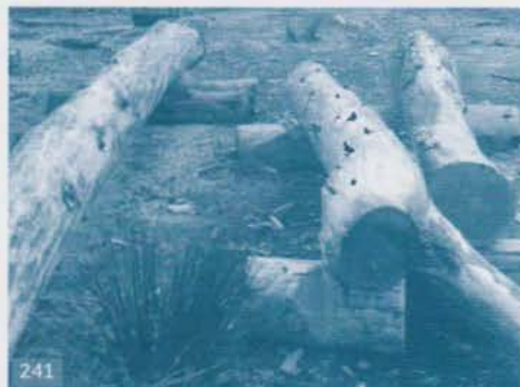
Mettre de côté les bois mal conformés : ils serviront pour les pièces courtes
