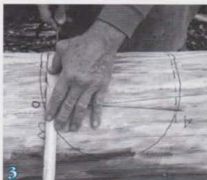
3 Le traçage modifié de la largeur du réglet.
