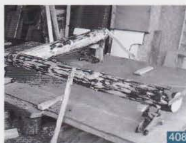
Chaque pièce est présentée sur l'aire de traçage avant épure définitive.
