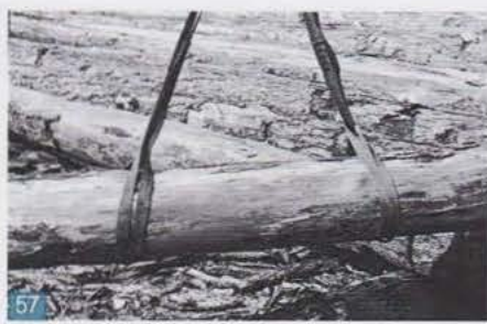
57 Deux sangles plates pour travailler en sécurité sans abîmer les bois
