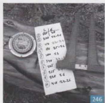
246 Etablir une fiche de débit avec un n° d'ordre, longueur et Ø recherché.
