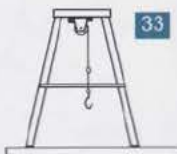
Un palan à chaîne ou électrique roulant sur une poutre
