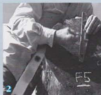
Tracer les axes et numéroté en bout.
